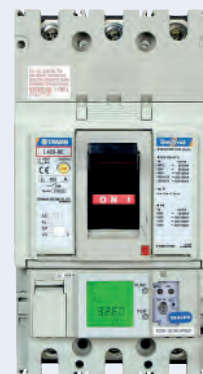
Elektroniczne zabezpieczenie przeciążeniowe nastawialne od 40% do 100% prądu znamionowego.
